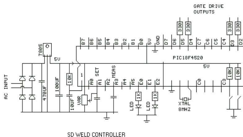
**FIGURE.6 DRIVER CIRCUIT USING PIC CONTROLLER**
