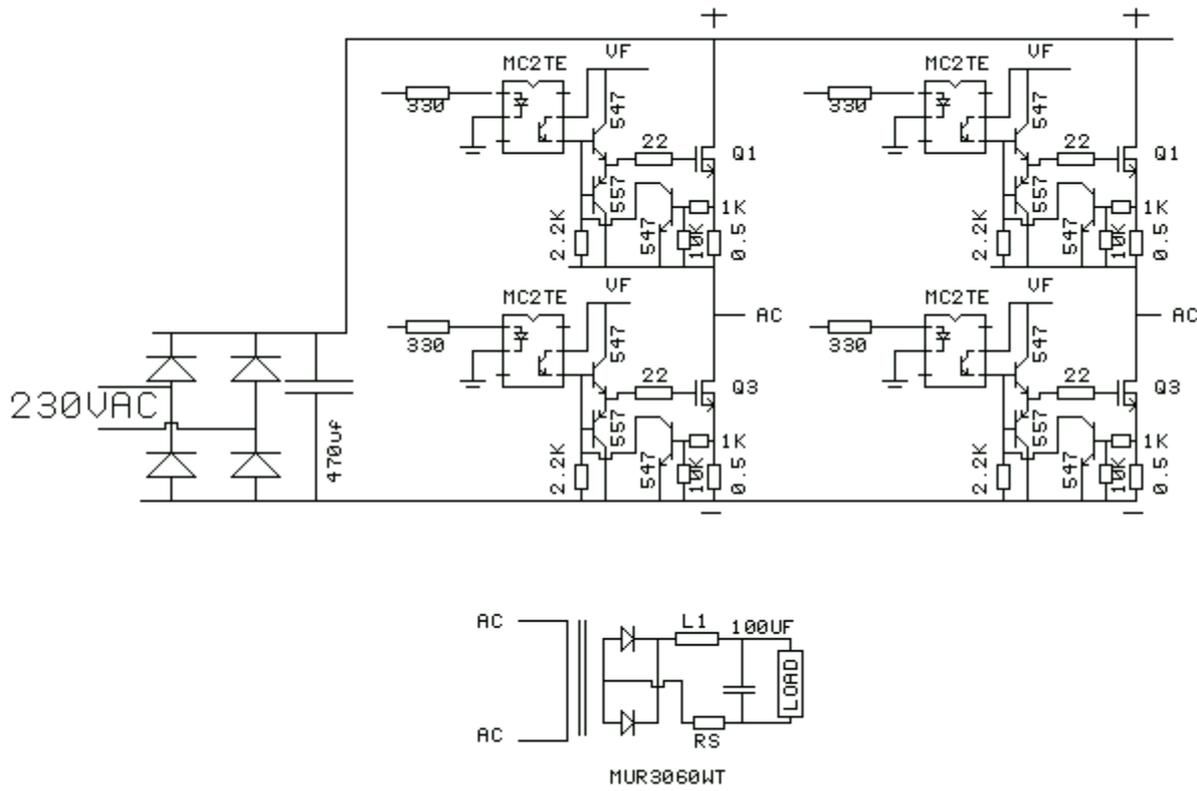
FIGURE.5 DRIVER CIRCUIT OF WELIDNG MACHINE
